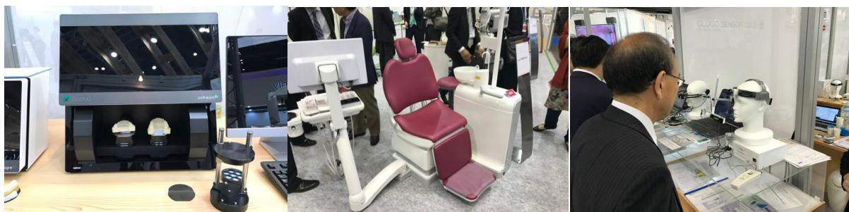
また注目を浴びていたのは新型スキャナー『Aadvantage スキャン D2000』。支台歯&歯列模型の一括スキャン、咬頭嵌合位の同時取得、上下顎模型連続スキャンと 3 つの機能を実現する『オールインワンスキャナー』のデンタルスキャナーです。今まででは、作業模型読み込み⇒支台歯読み込み⇒対合歯読み込み⇒噛み合わせ読み込みと行っていた作業を、計測物を入れ替えることなく、1 回のスキャンで計測作業を効率的に行えます。医院様ラボ様でのお仕事をより効率化するためにも、導入を検討されては如何でしょうか。
